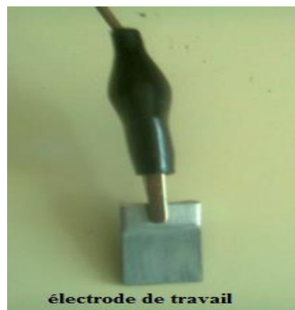
Figure II.4 : exemple d'une électrode de travail (Acier inoxydable)
