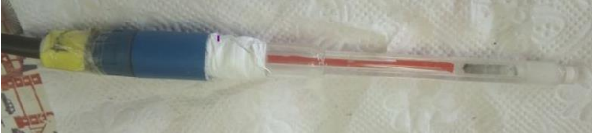
Figure II.3 : Schéma d'une électrode au calomel saturé
