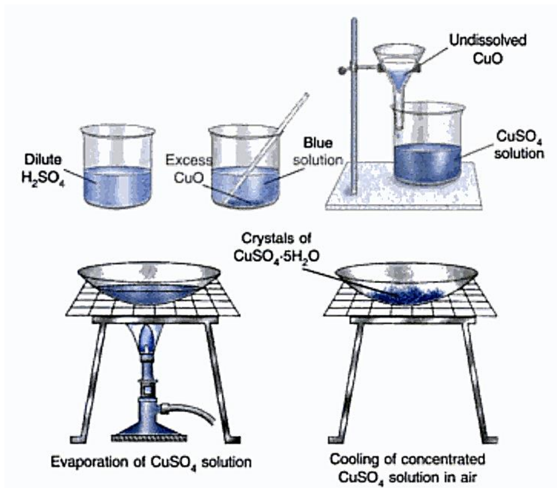
Figure I. 6 : Préparation du sulfate de cuivre anhydre à partir de l'oxyde de cuivre [3].
