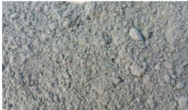
Figure III.8: Cendres volantes en poudre [155].
