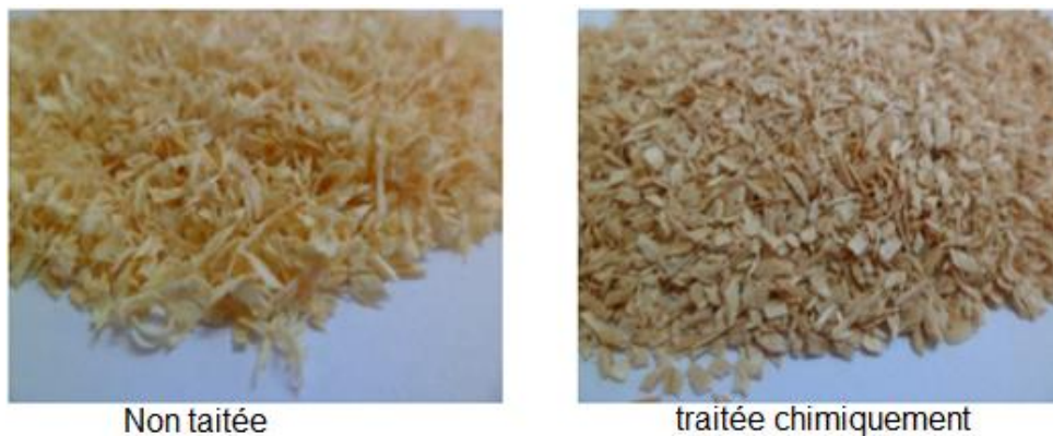
Figure III.6 : Morphologie superficielle de la sciure de bois [134].
