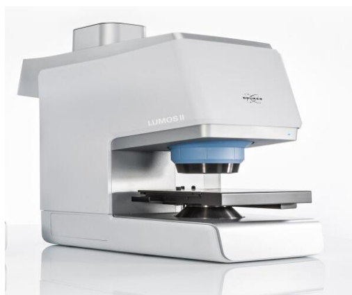
Figure III.4 : Appareillage FTIR utilisé pour les observations microscopiques des échantillons [120].
