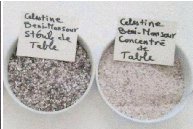
Figure II.15 L'aspect du concentré marchand et des rejets de tables. Granulométrie : 0-2mm
