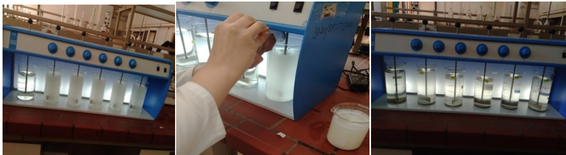
Figure 22 : (a) : injection du coagulant ; (b) : agitation ; (c) : décantation (Cliché par Akkal & Mertousse, 2019).
