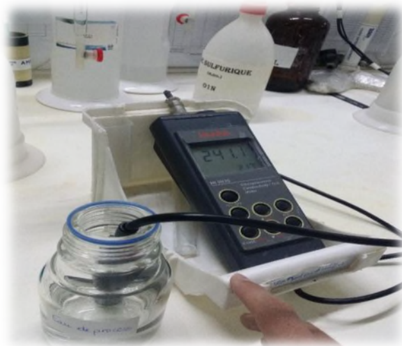
Figure (03) : technique de mesure de la conductivité de l'eau de process.
