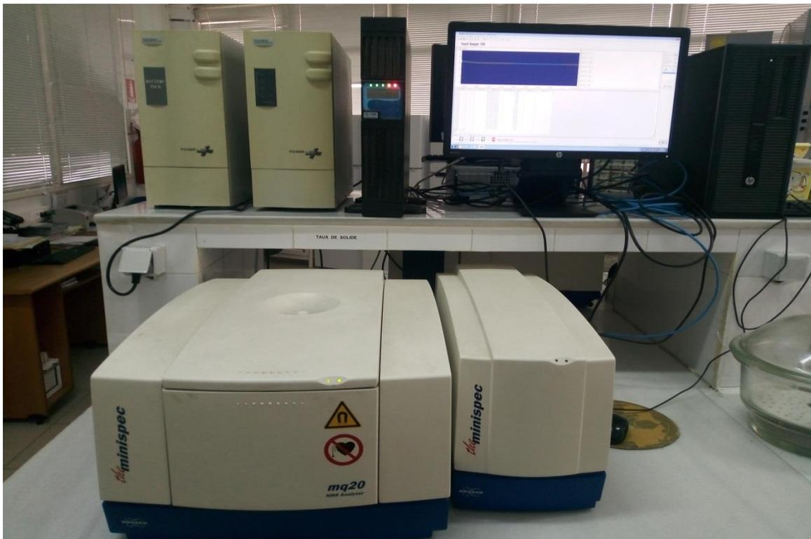
Figure 18: Photo d'un spectromètre à résonance magnétique nucléaire (RMN) (minispec mq 20, allmagne).
