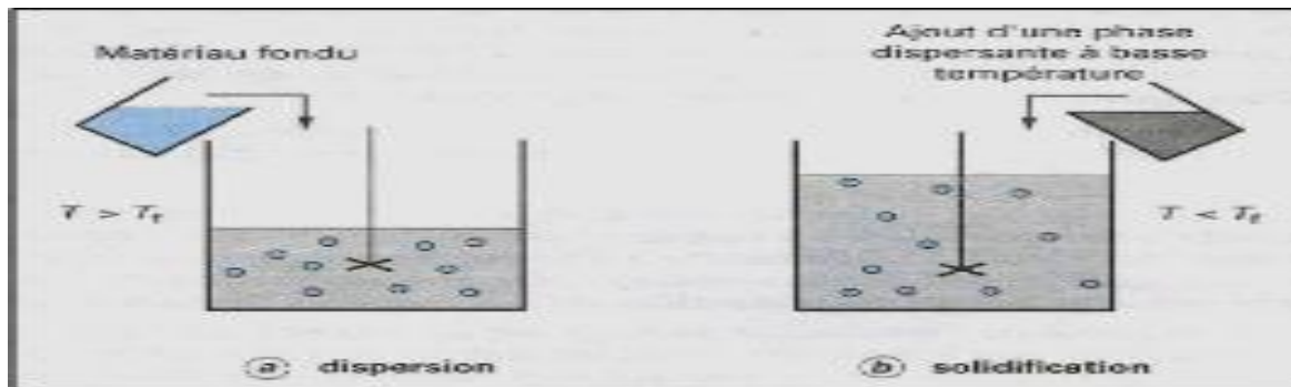
Figure III.13: Schéma de principe du procédé d'encapsulation par gélification thermique.[29].
