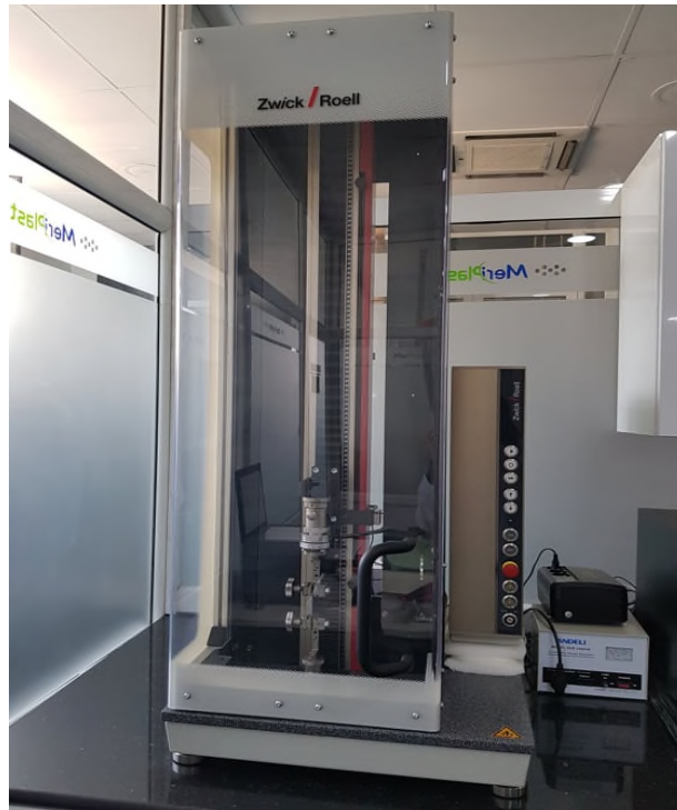
Figure 15 : Appareil de traction de type Zwick-Roell.
