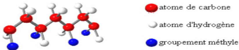
Figure 3 : schéma de la configuration syndiotactique du polypropylène.
