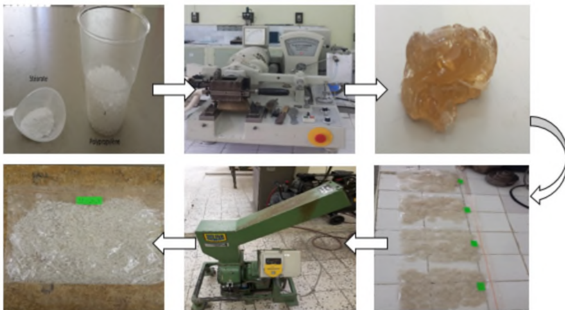
Figure 9 : Processus d'obtention des granulés par malaxage.
