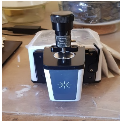
Figure 12 :L'appareil Agilent technologies carty 630 FTIR pour l'analyse IR ATR.
