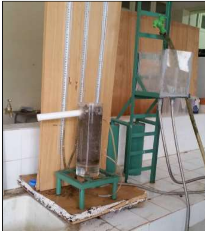
Figure (II. 6) : dispositif expérimental de mesure de la perméabilité
