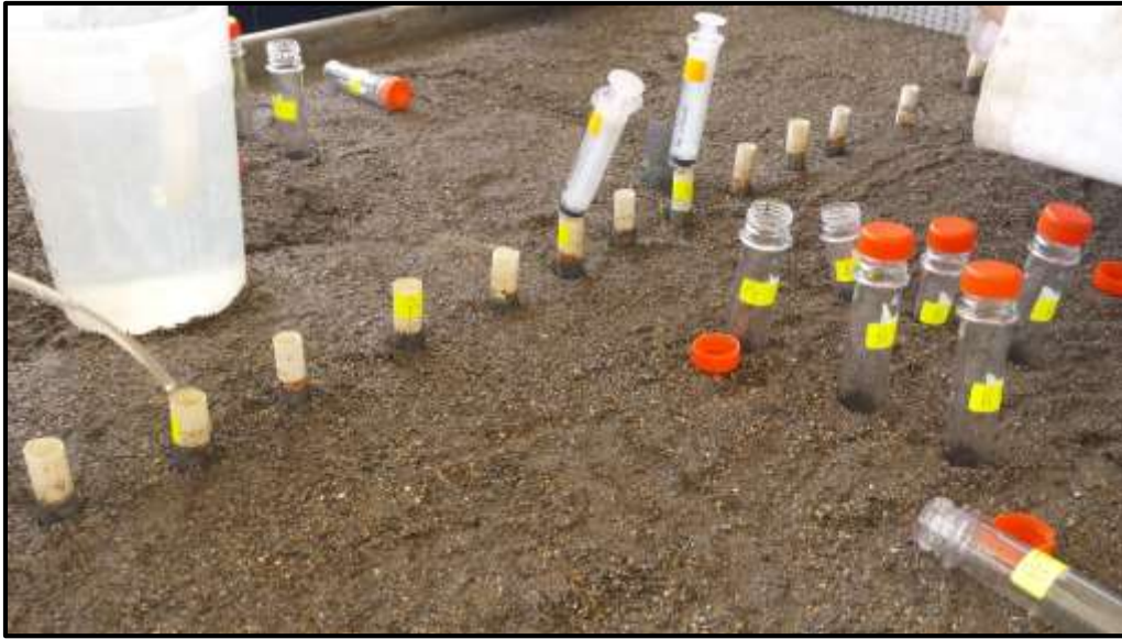
Figure (II.13) : Prélèvement des échantillons au niveau des piézomètres
