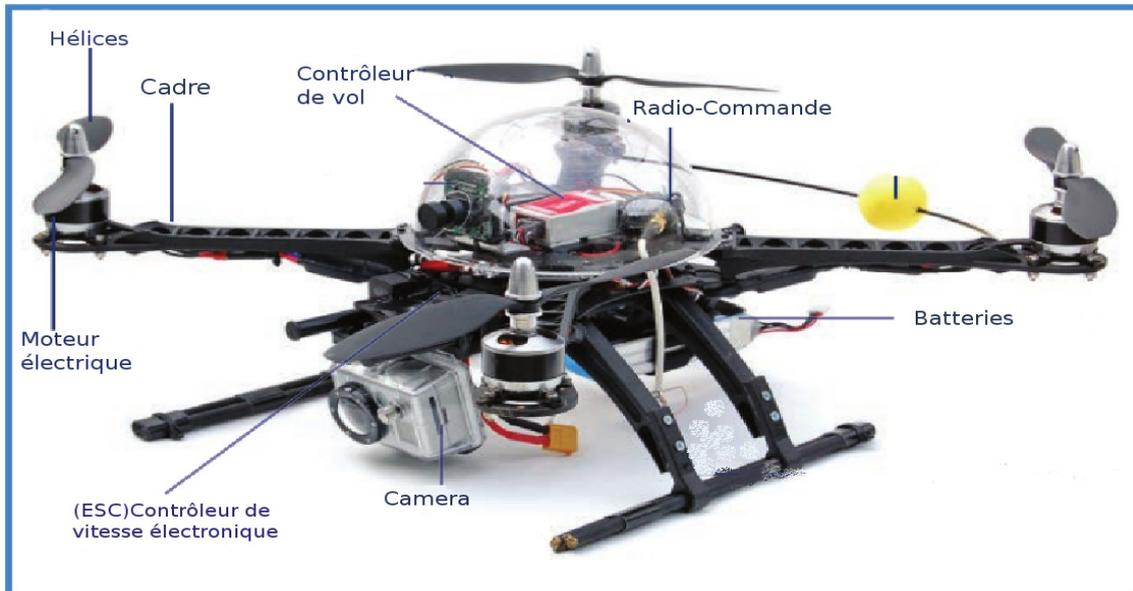
FIGURE I.1 – Les composants d'un quad-copter [3]
