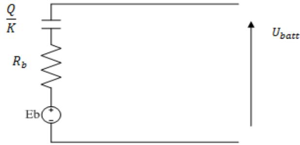
**Figure III. 9 :** Modèle de traction.
