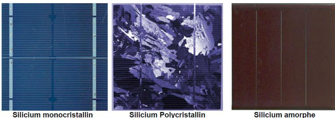
**Figure I.5 :** Cellules photovoltaïques au silicium cristallin.
