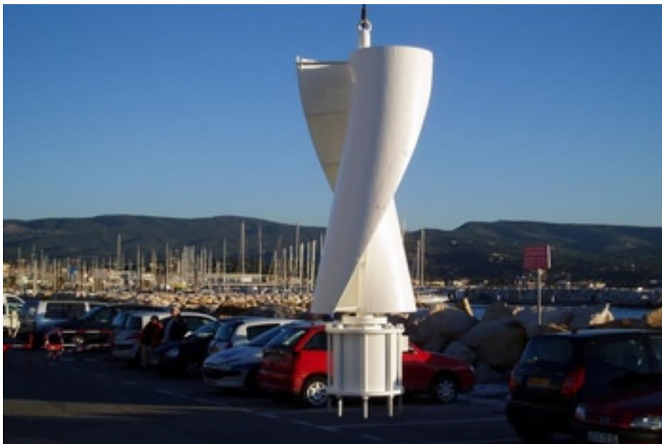
**Figure I.4** : Eolienne a axe vertical
