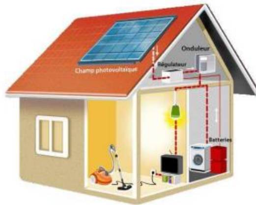
Fig. I.1 : Système photovoltaïque autonome. [8]
