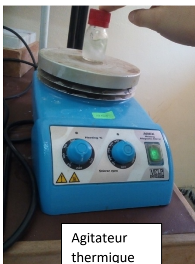
Figure II.3: Dispositif de préparation de solution (2) silice-zircone
