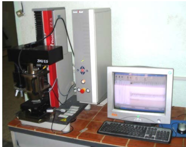
Figure II. 14 : Microduromètre utilisé Zwick/Roell
