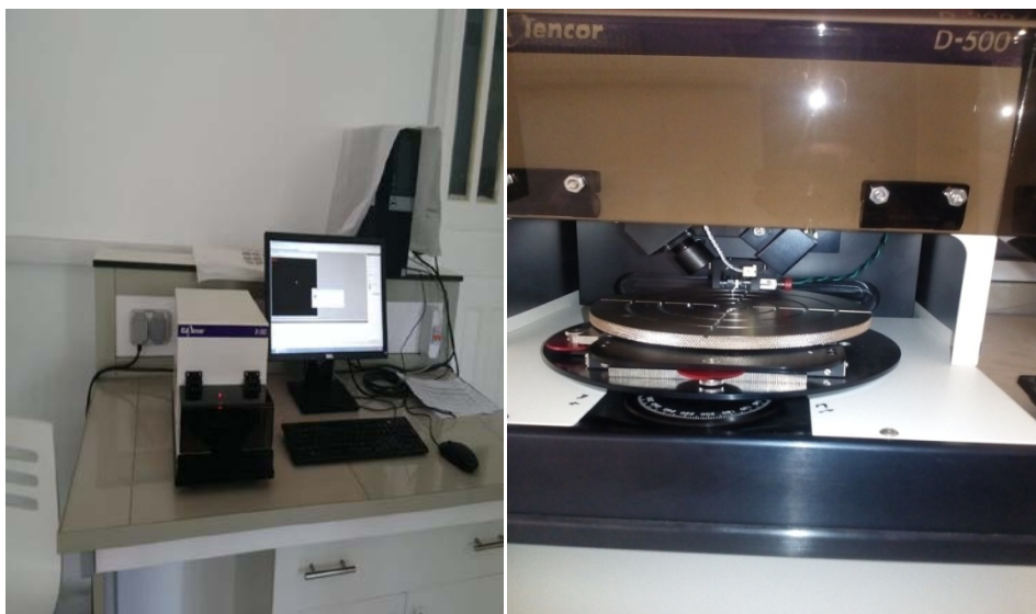
Figure II.11 : profilomètre mécanique kla /tencor D-500
