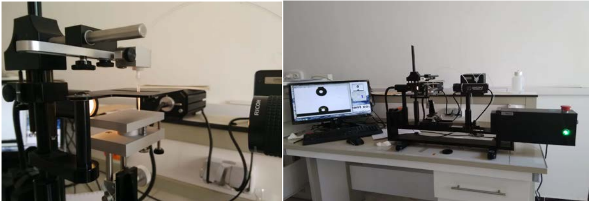
Figure II.13 : Machine à mesurer l'angle de contact
