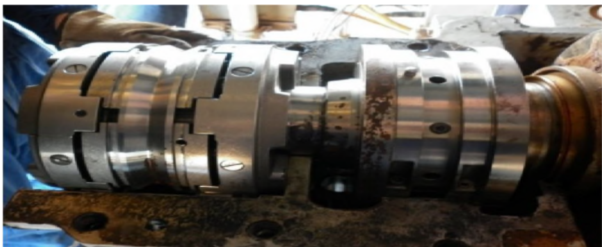
Figure 3.10 : palier de butée
