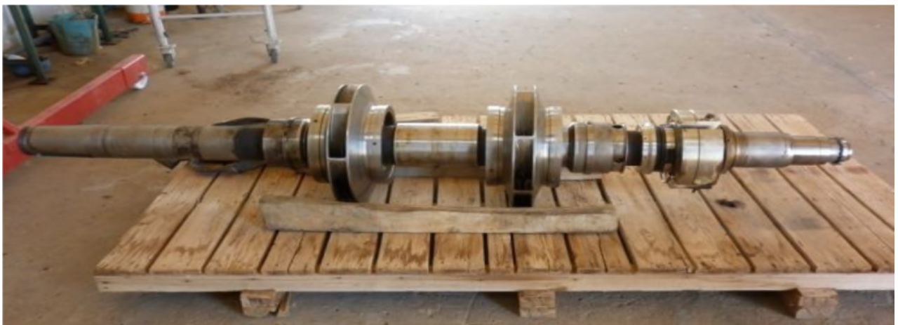
Figure 3.8 : l'arbre de la pompe
