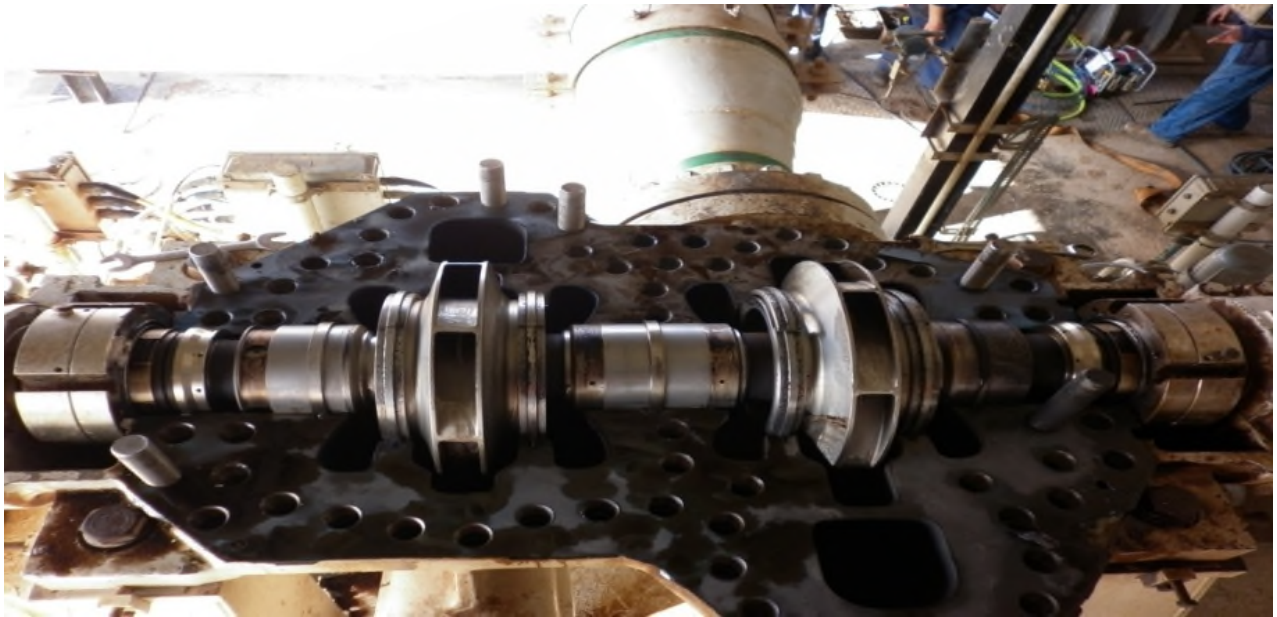
Figure 3.6: demi-cout inferieur partie mobile
