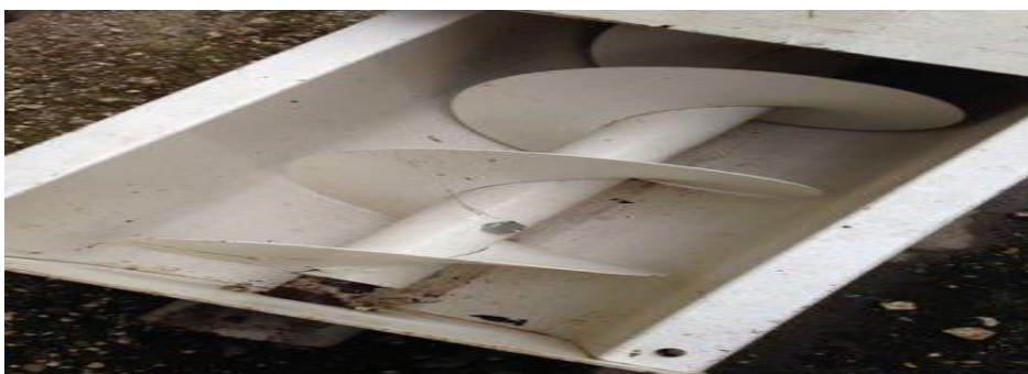
Figure I.8: machine élévatrice à vis d'Archimède
