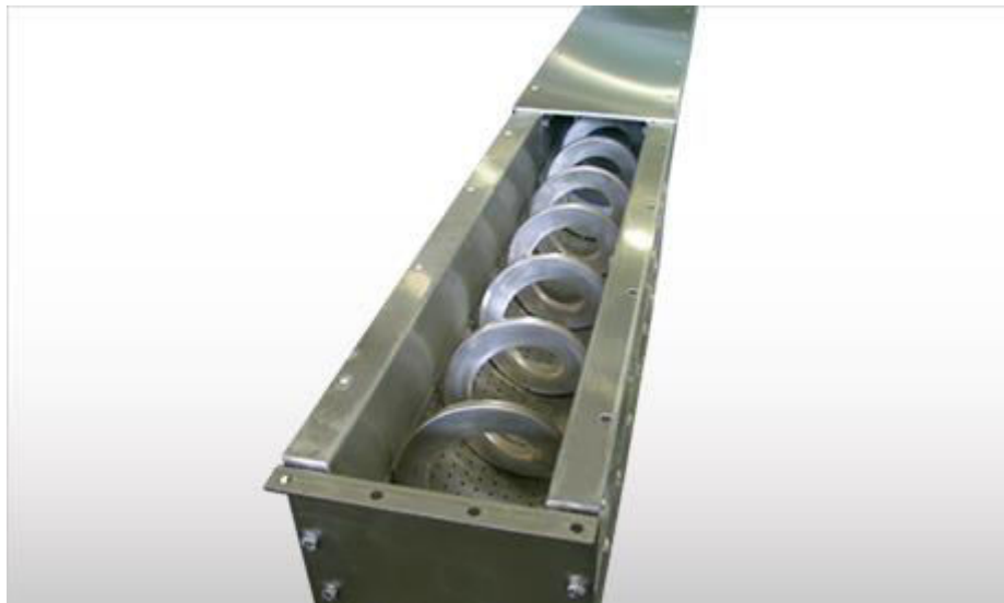
Figure I.2 : vis d'Archimède sans âme.
