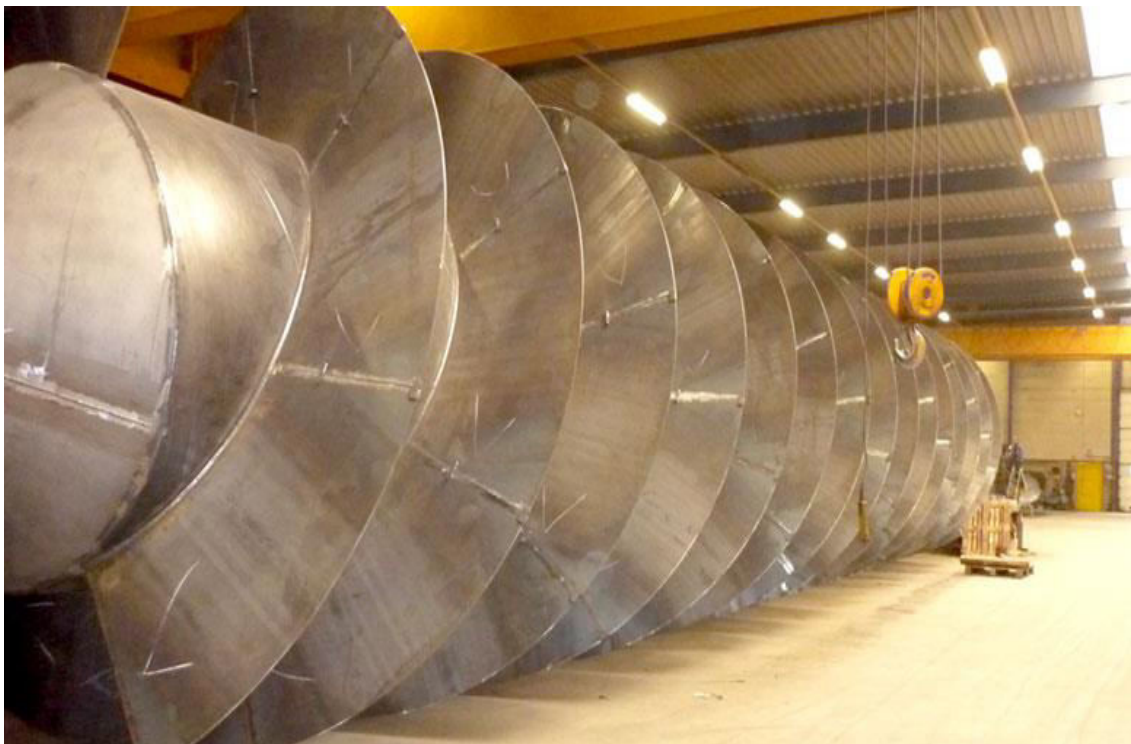
Figure I.1 : vis d'Archimède avec âme.
