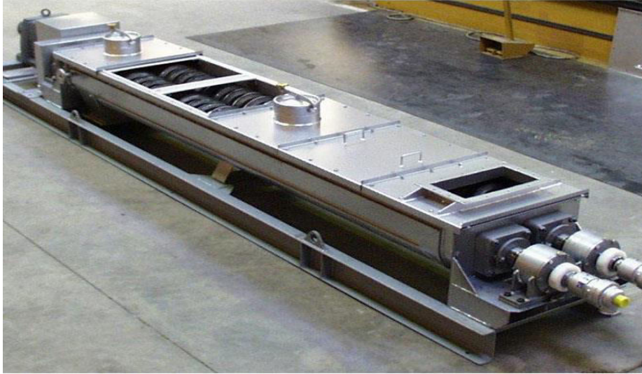
Figure I.7 : échangeur thermique à vis d'Archimède a double rotor
