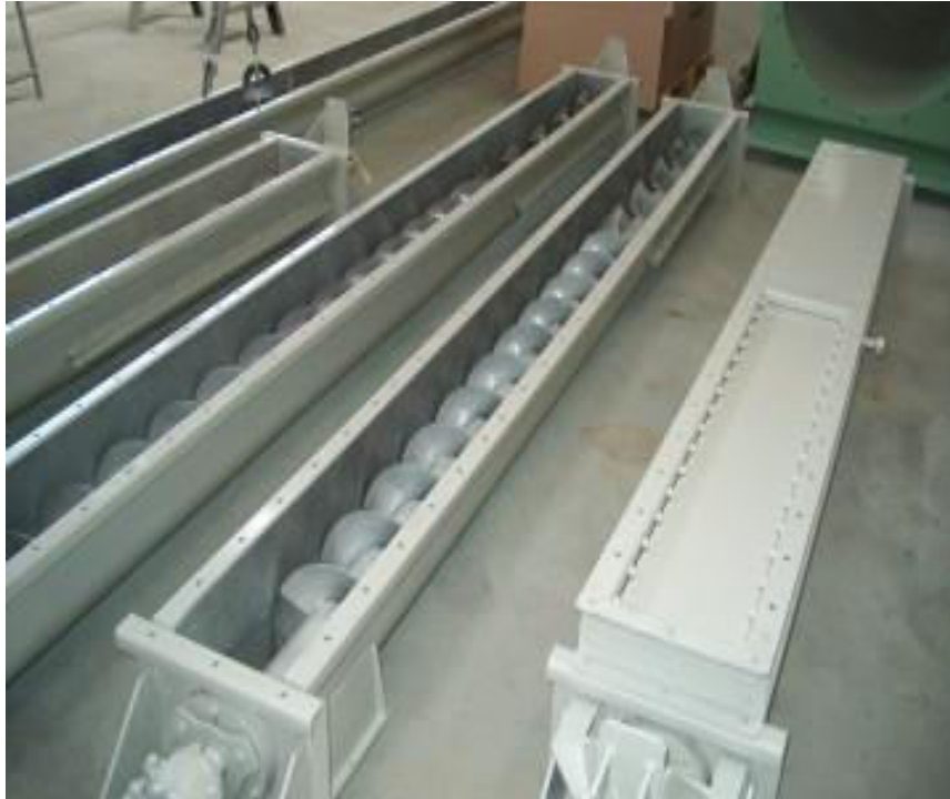
Figure III.2 : vis d'Archimède avec auge.
