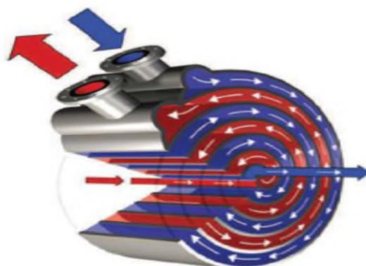
Figure II.9 : Échangeur à spirale [8]
