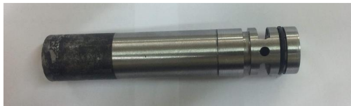
Figure IV.5- Axe de distributeur
