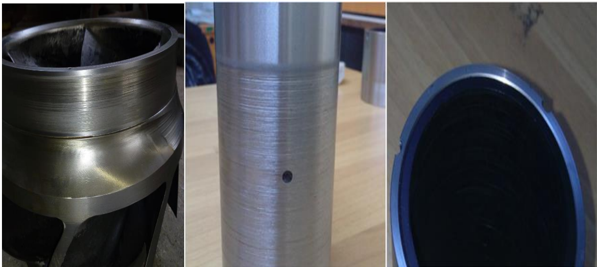
Figure III.II.3. Dégradations des pièces de contact lors de la révision.
