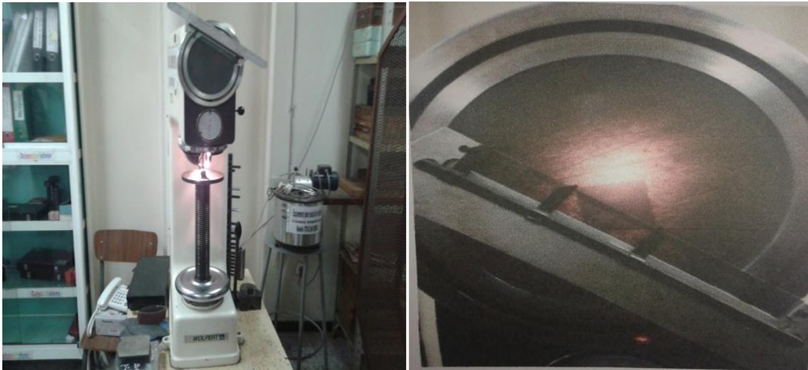
**Figure II.9** Essai de dureté Vickers.
