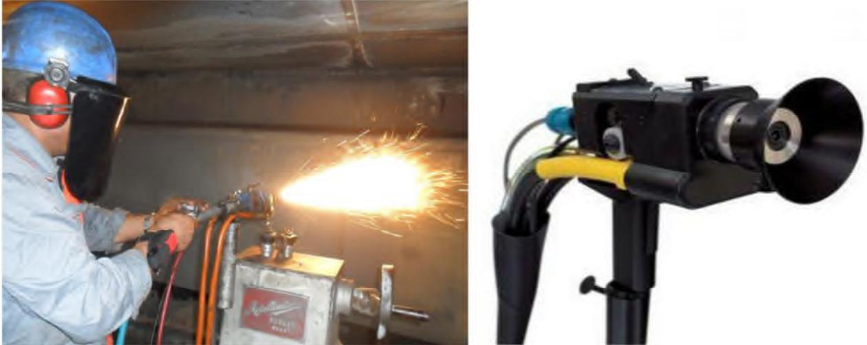
**Figure II.3 :** Pistolet arc électrique entre deux fils.
