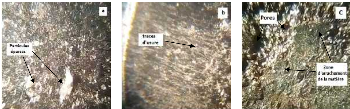
Figure III.40 : Traces d'usure des surfaces des différents échantillons obtenue après le test tribologique : a) 0.5 (m/s), b) 1(m/s), c) différentes charges appliquées.
