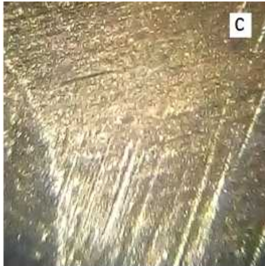
Figure III.21 : Traces d'usure des surfaces des différents échantillons obtenues après le test tribologique : a ) 0.5 (m/s), b ) 1(m/s), c ) différentes charges appliquées.
