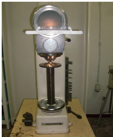
Figure II.2 : Machine de dureté universelle Brinell, Vickers et Rockwell de l'UGB.
