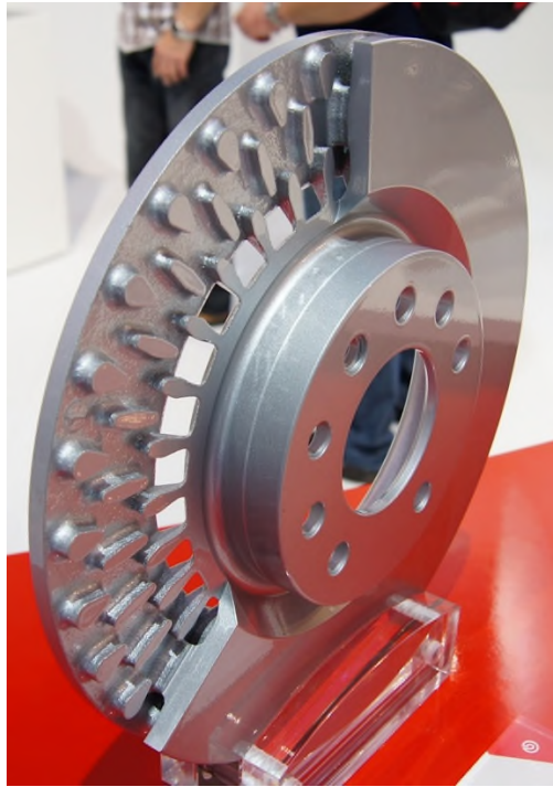
Figure I.15 : Coupe sur un disque ventilé [14].
