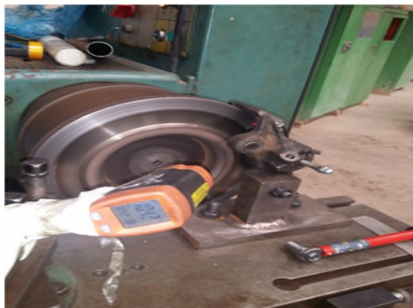
Figure II.13 : Montage du dispositif, du disque et du thermomètre sur le tour.
