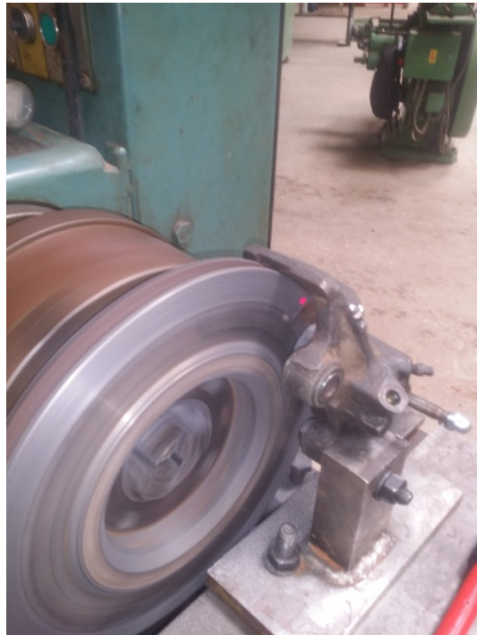
Figure II.8 : Montage du dispositif sur le tour.
