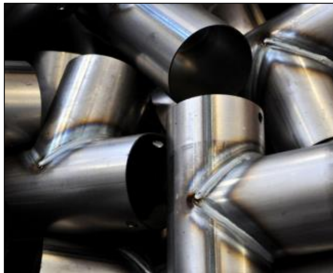
Figure II.13 Deux tubes soudés sous forme de T
