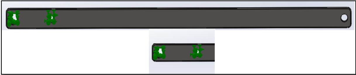
Figure IV.21 Fixation au niveau des alésages des axes pivots
