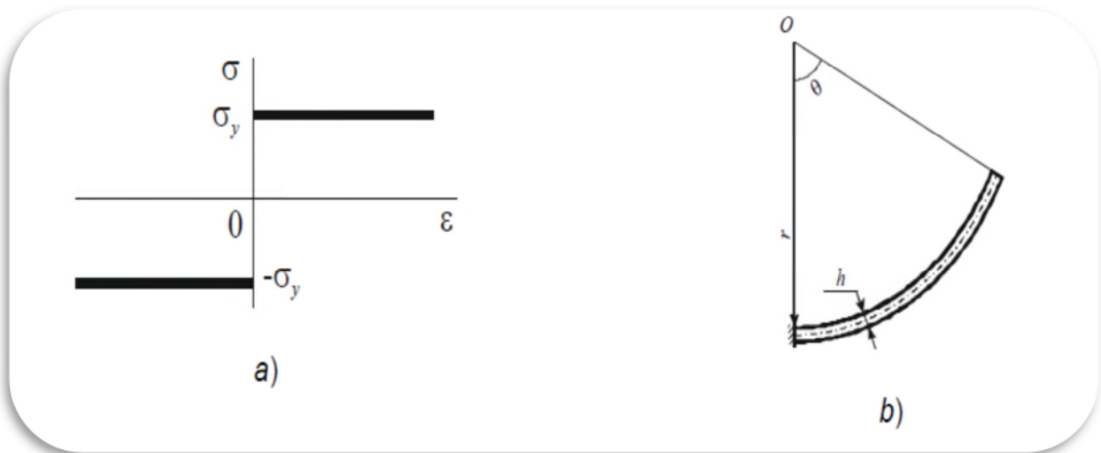
Figure III-11 : a)exemple de relation contrainte-déformation et b) le modèle analytique de rayon de courbure [11].
