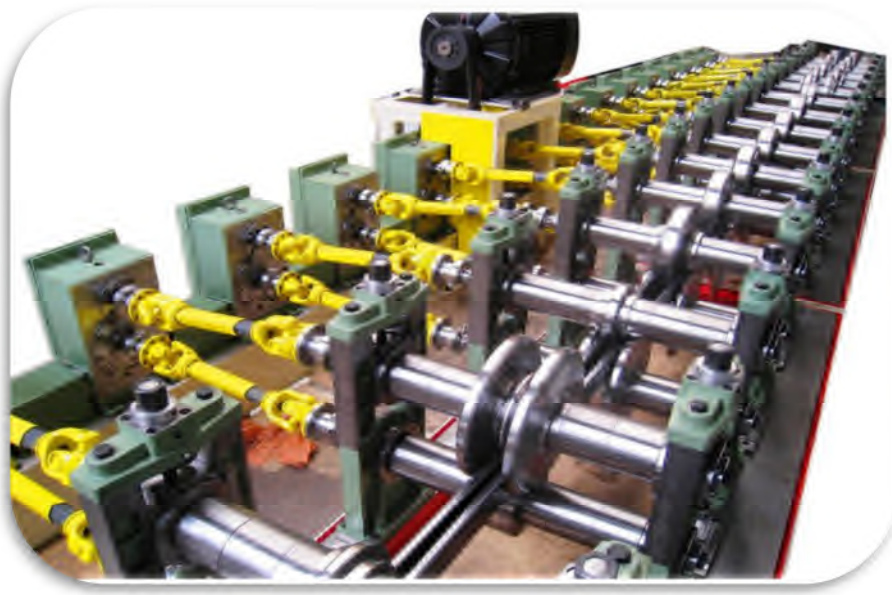
Figure I-3: Exemple d'une profileuse de tôles à cardans [6].
