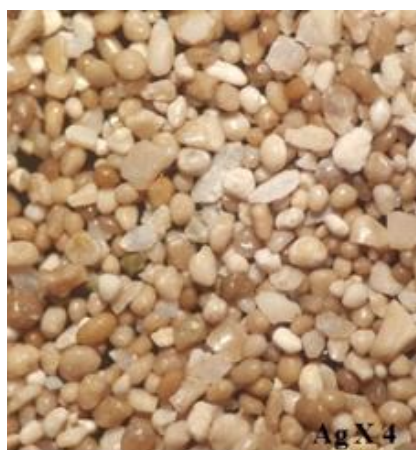
Figure. 45. Le produit broyé et lavé sur la loupe binoculaire de la fraction granulométrique 0,100-0,315 mm du phosphate de la couche principale. [58]
