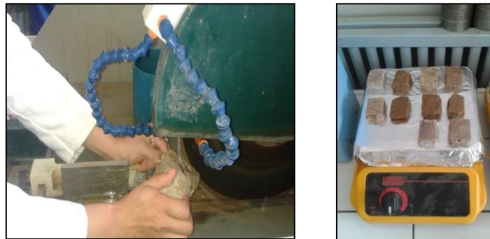
Figure. 14. Réalisation des tranches
