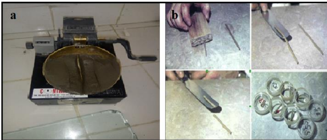
Figure II.4: Fermeture de la rainure (a) et rouleau de 3 mm (b).
