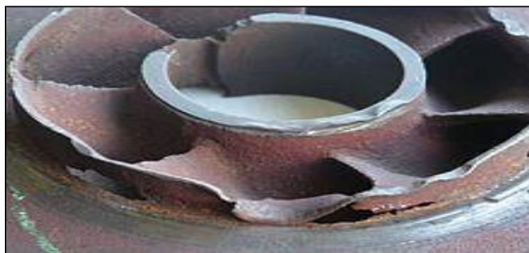
Figure III.15 : la cavitation d'un impulseur dans une pompe centrifuge [9].
