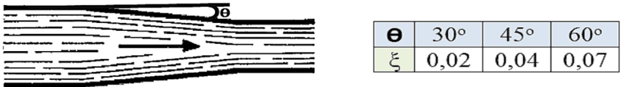
Figure III.8 Variation du coefficient \xi dans un convergent en fonction de l'angle \theta
