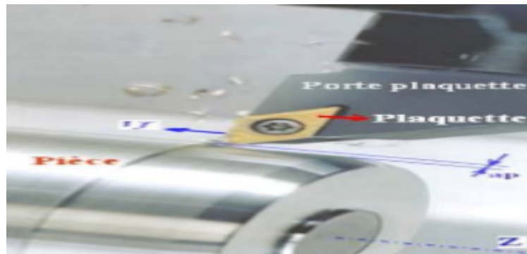
Figure I.7: Opération de chariotage en tournage [8].
