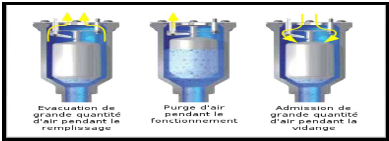
Figure (VI.10) : Schéma explicatif du fonctionnement d'une ventouse.
