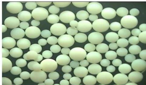
**Figure 7:** Résine échangeuse d'ions.
