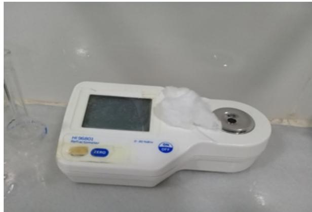
**Figure 6:** Réfractomètre type « HI 96801 »
