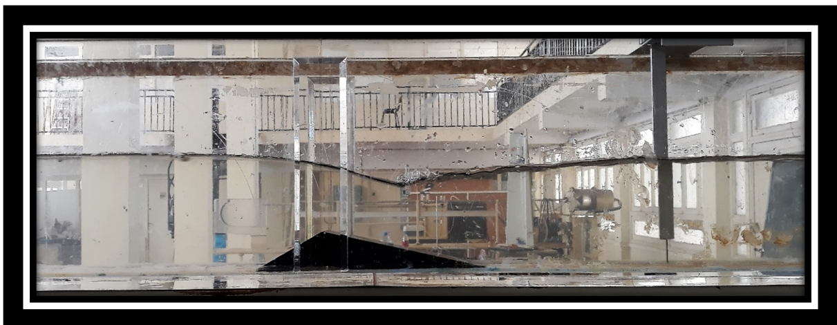
Figure (II-8): Visualisation de l'écoulement noyé transitoire à travers le déversoir de CRUMP
