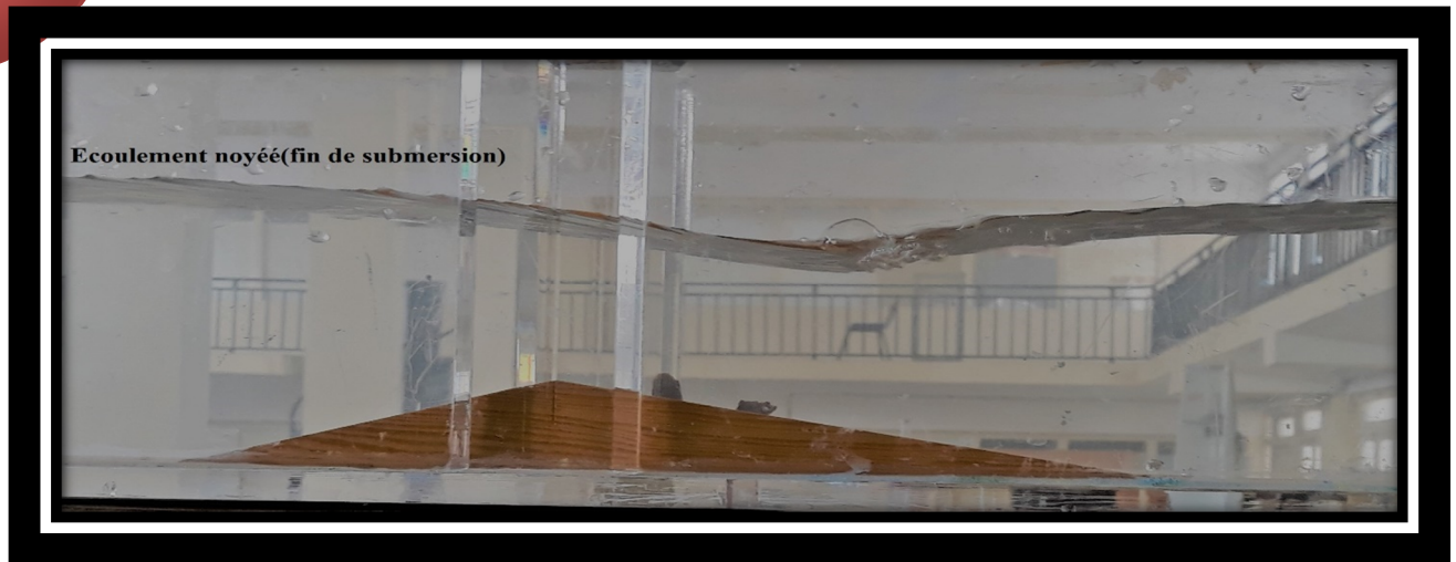
Figure (II-11) : Visualisation des écoulements à travers le déversoir de talus (3 :5)
