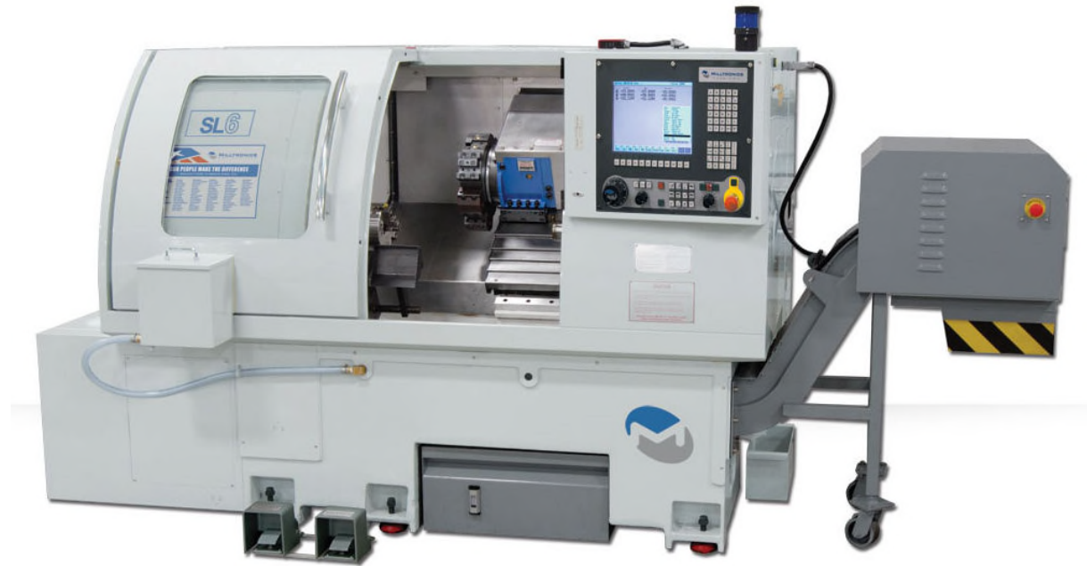
Figure. I.6 - Tour a commande numérique avec convoyeur copeaux [8]
