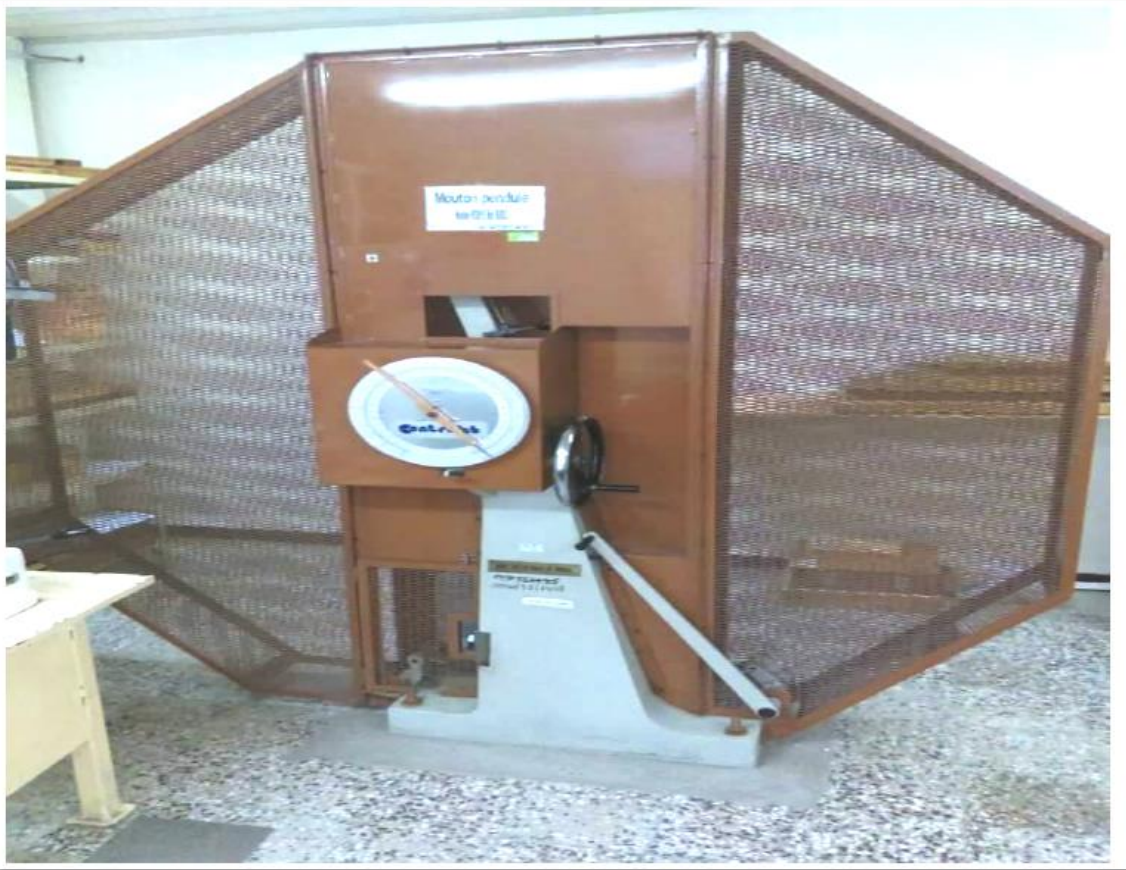
Figure 2.9 : Mouton pendule Charpy de capacité 300J
