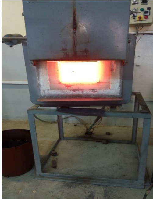
Figure 2.2 : Four électrique disponible au laboratoire Fonderie du département génie mécanique au niveau du hall de technologie.
