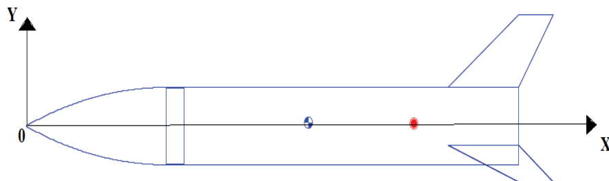
Figure 2.11 : La distance entre le centre de masse et le point zéro du repère
