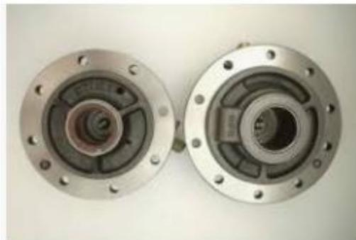
**Figure II.11 :** Pompe à huile du compresseur.
