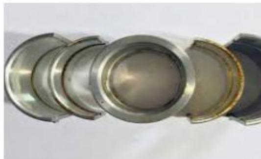
**Figure II.7 :** Coussinets de ligne d'arbre.
