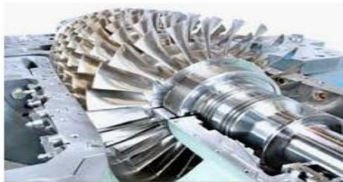
**Figure I.2:** Rotor de compresseur axial.
