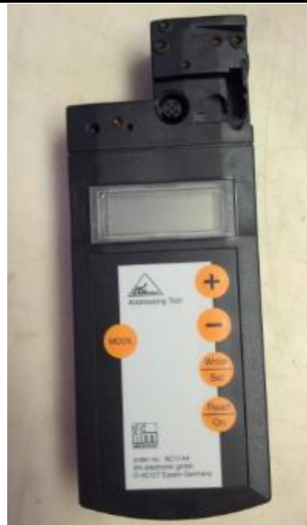
Figure III. 18 Module d'adressage AS-i
