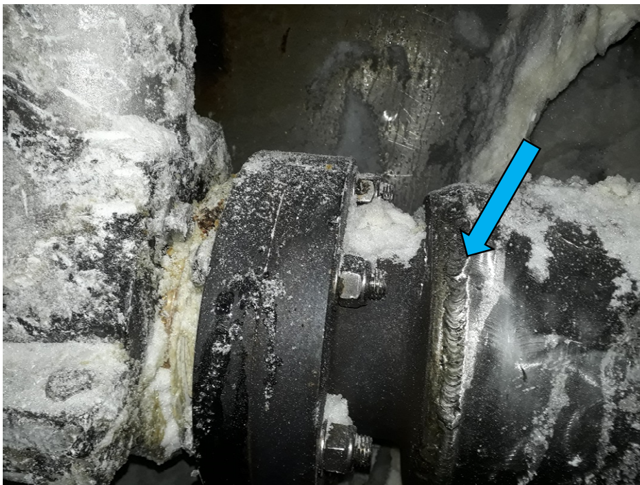
Figure III 7: Le lubrifiant sur les coté de coussinet
