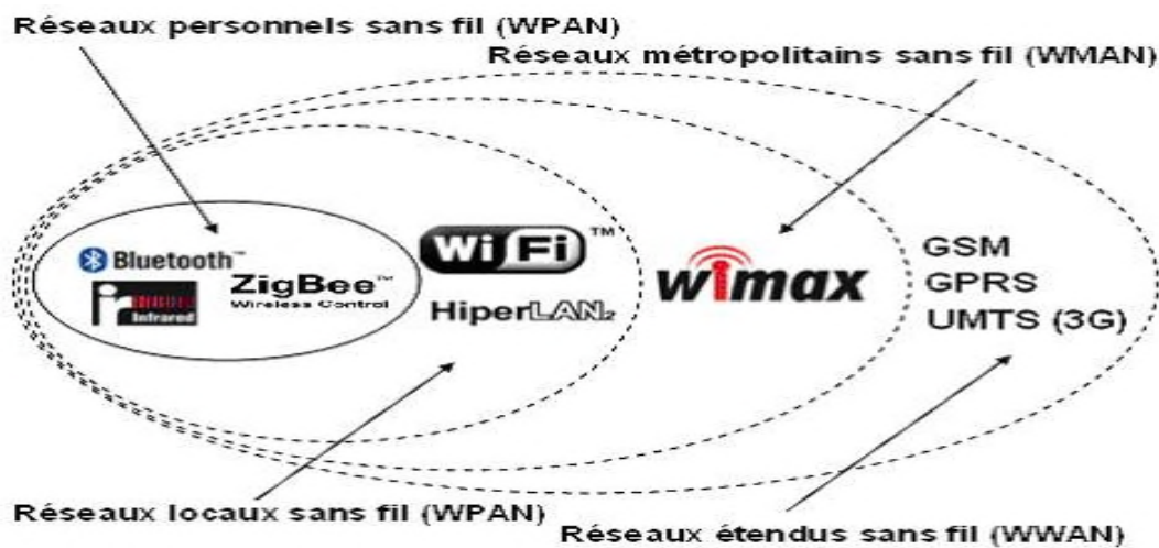
Figure 1: présentation des différents réseaux sans-fil et mobiles
