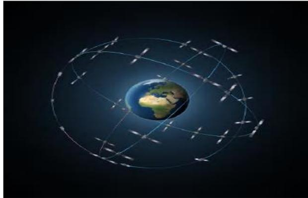
**Fig. 1.4 :** Constellation satellitaire du système GALILEO.
