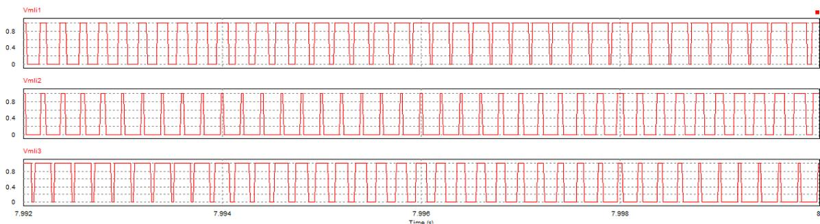
**Figure IV.9** Signaux de commande de l'onduleur
