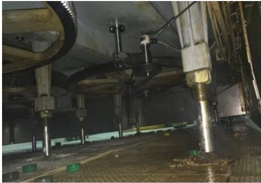
Figure I:26 : système d'engrenage de la remplisseuse bouchonneuse.
