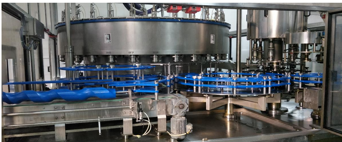
Figure I.1 : Remplisseuse bouchonneuse de bouteilles d'huile 5/10L.
