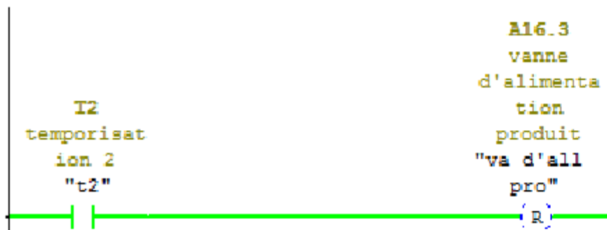
Figure III:17: arrêt pompe et temporisation de l'EV.
