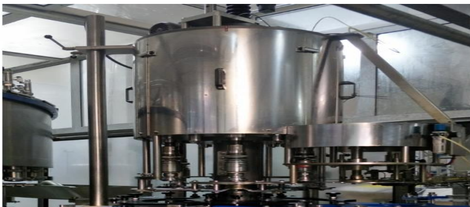
Figure I:21 : Tourelle de bouchage TCS.
