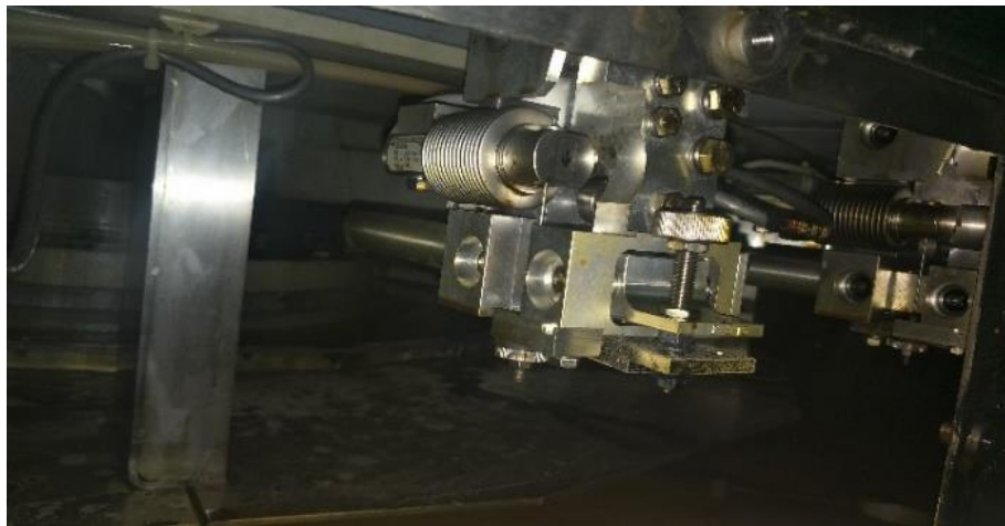
Figure I:8 : capteurs de poids à jauges de contrainte.
