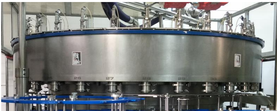
Figure I:15 : tourelle de remplissage.
