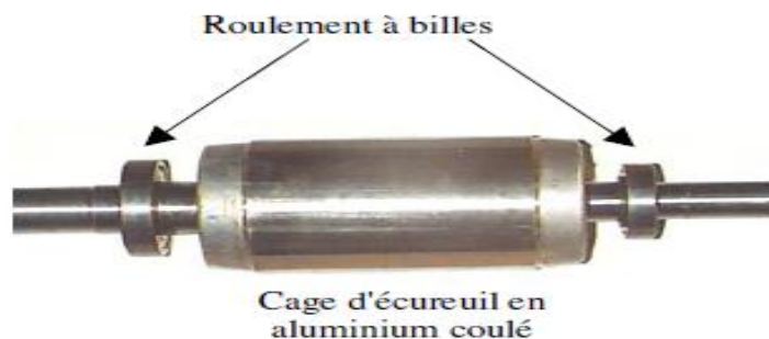
Figure (I.3) : Photo du rotor d'une machine asynchrone.
