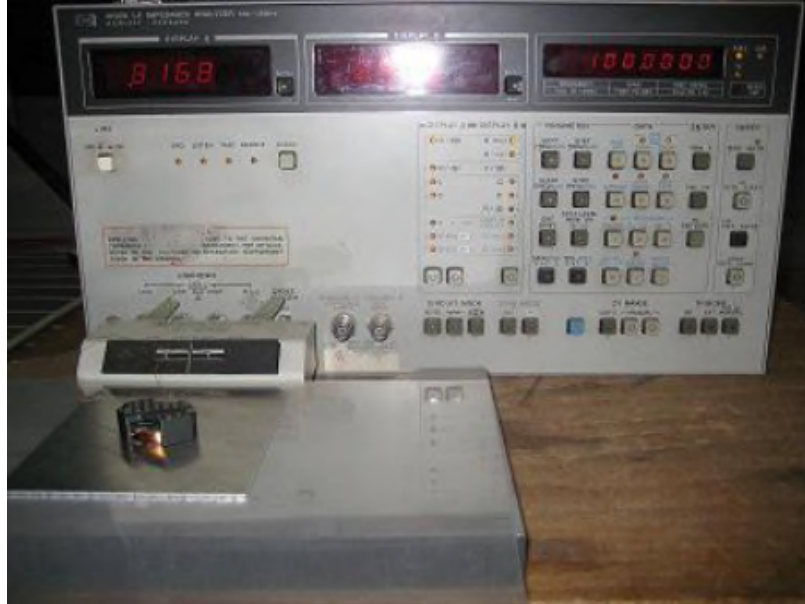
Figure IV.6 : Analyseur d'impédance Agilent 4294A, capteur courant de Foucault et structure testée
