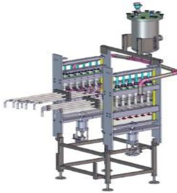
Figure (III. 14) : Schéma de la Trémie Doseur[30]
