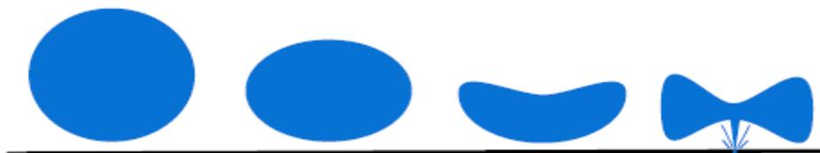
**Figure 03:** Evolution d'une bulle de cavitation à proximité d'une surface solide (Pétrier et al., 2008).
