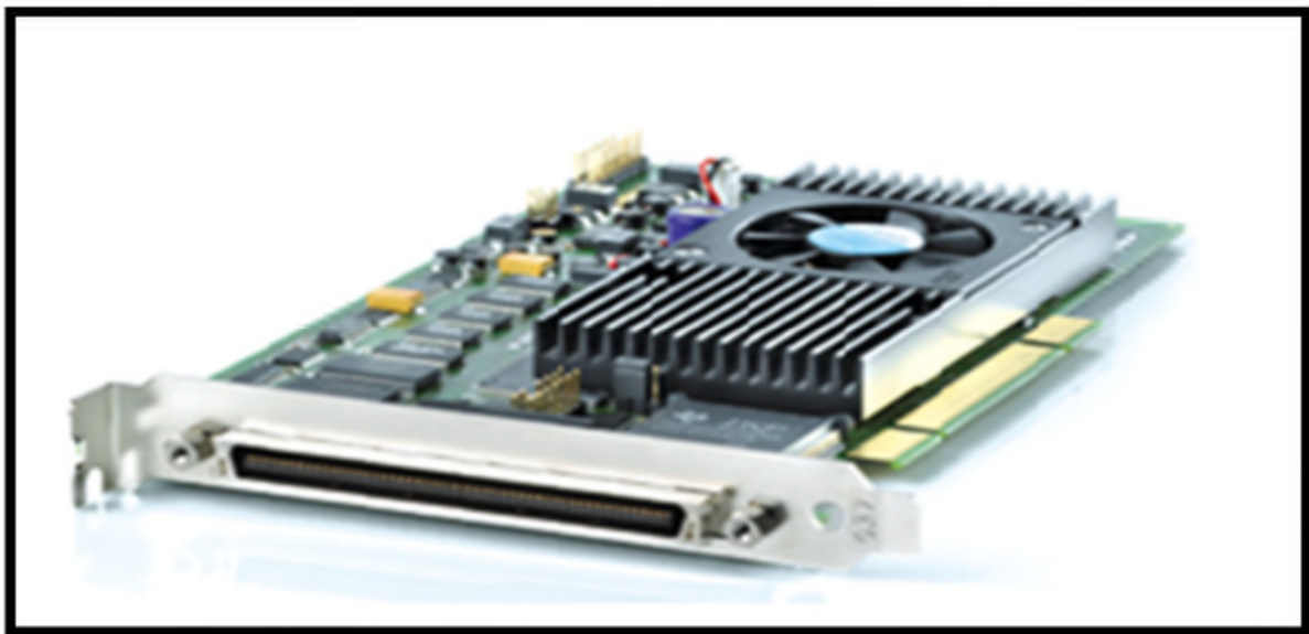
Fig. III.9 : Carte d'acquisition de la carte dSPACE 1104.
