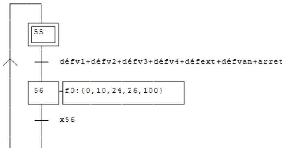
**Figure III.2 :** Graficet d'arrêt/arrêt d'urgence
